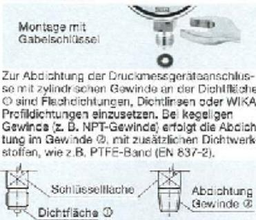
Zur Abdichtung der Druckmessgeräteanschlüsse mit zylindrischen Gewinde an der Dichtfläche sind Flachdichtungen, Dichtlinien oder WIKA-Profildichtungen einzusetzen. Bei kegelförmigen Gewinde (z. B. NPT-Gewinde) erfolgt die Abdichtung im Gewinde mit zusätzlichen Dichtwerkstoffen, wie z. B. PTFE-Band (EN 837-2).
