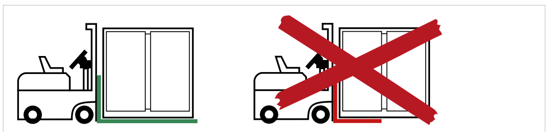
Abb. 8 Mit Gabelstapler transportieren
